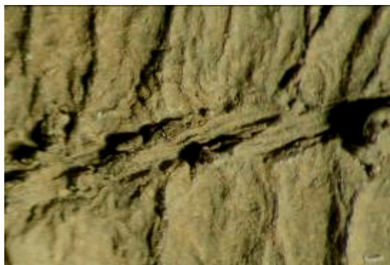
Fig 3. Den fine syning ved sammenføjnningen i siden forstørret 20 gange
